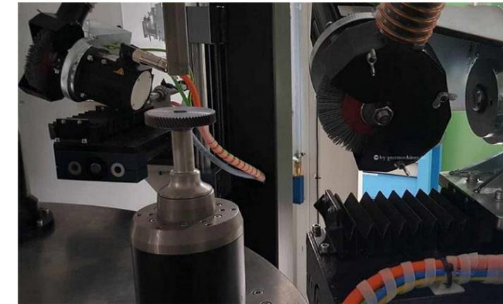
Diese Entgratmaschine wurde zum Entgraten von gerad- und schrägverzahnten Stirnrädern, geradverzahnten Kegelrädern sowie Ritzeln und Wellen mit einem Durchmesser von 20 – 400 mm entwickelt. Somit können auf der können verschiedene Werkstück-Typen bearbeitet werden. An der Steuerung sind für alle Varianten entsprechende Bearbeitungszyklen hinterlegt, die individuell angepasst werden können. Für die Entsorgung des anfallenden Staubes ist eine Absaugung integriert.
